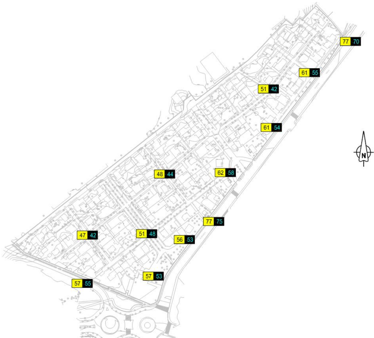
Ilustración 2. Niveles sonoros equivalentes utilizados para calibrar el modelo (2013) – DIA/NOCHE.
