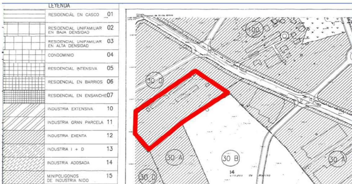
Detalle del Plano de Calificación, del que resulta la aplicación de la ordenanza 12: Industria Exenta de las NN.UU. del PGOU.
